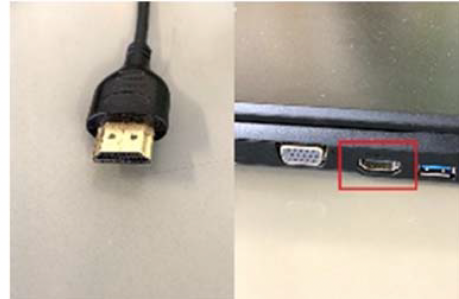
図 1. HDMI コネクタ (左) と HDMI 端子 (右)
